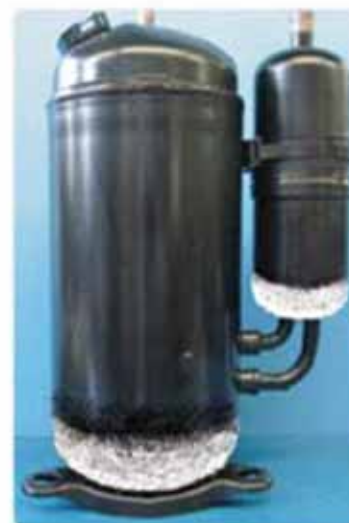
【圧縮機及び アキュムレーター底部の霜付き】
