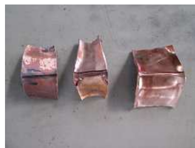
ろう付部を切断し内側評価
